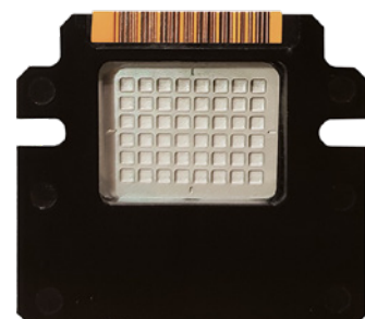
Microchip de acero inoxidable de 48 microrreactores
