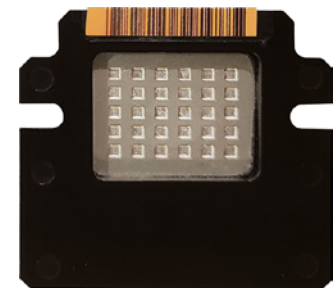
Microchip de aluminio de 30 microrreactores
