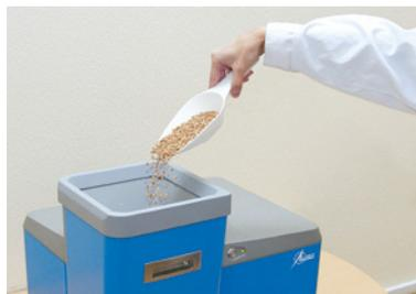
Llene el grano en el eje del InfraLUM FT-12 Whole Grain, elija el producto que analizar en el menú e inicie la medición.
